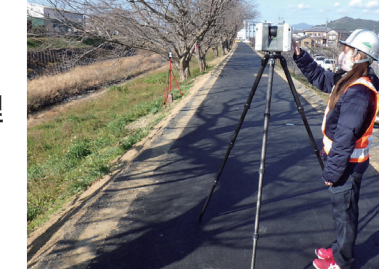
TLS (地上型レーザースキャナー) 測定
