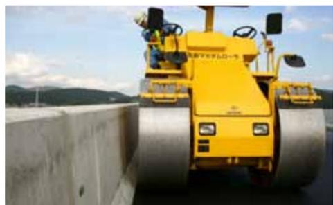
また、ロールを支えるサイドフレームが無いため、既設舗装部への張り出しも少なく、交通開放区域と隣接した施工現場においても一般交通車両との接触・衝突事故の低減に寄与します。
