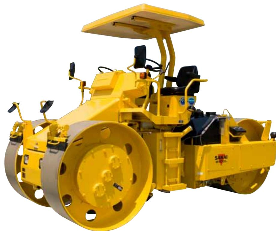
舗装用締固め機械
